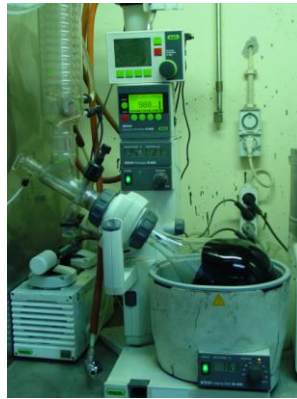
Figura 2: Processo de envelhecimento do betume no rotovapor
